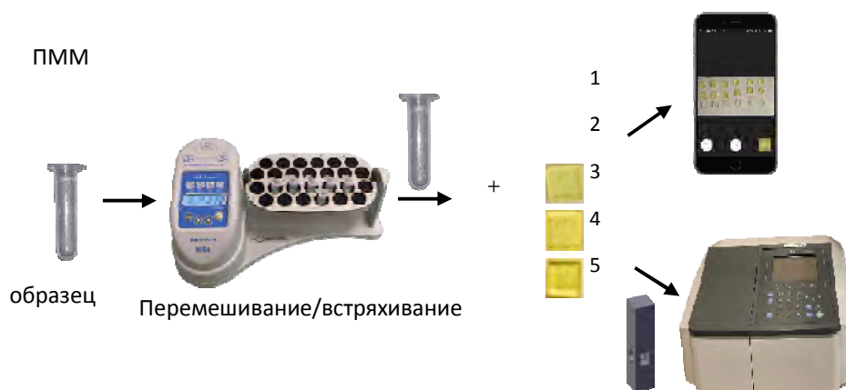
Рис. Схема определения аналита с использованием ПММ
